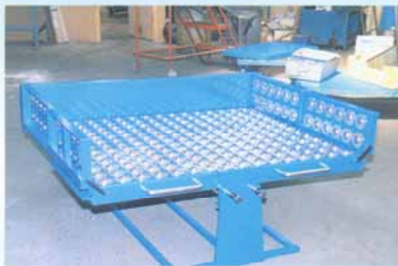
結合重力架使用的傾斜式滾珠平台
