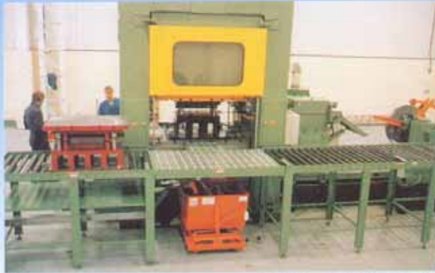
在 Premier Spring & Presswork 設計、製造及安裝的 沖模 / 工具工作盤
