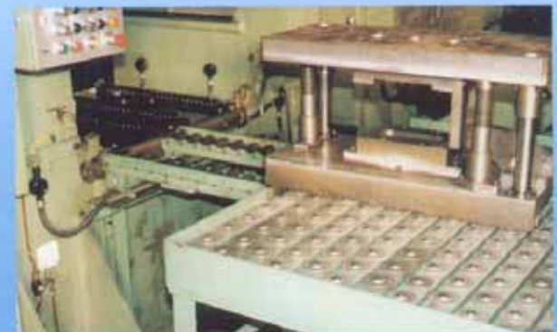
連接動力沖壓機以快速更換工具的換模工作盤
