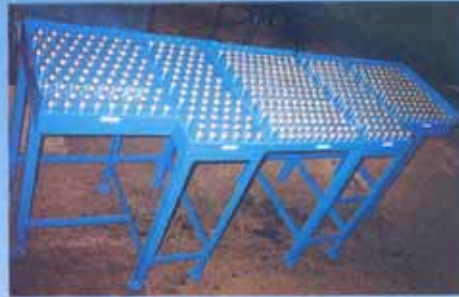
組裝區用的滾珠平台
